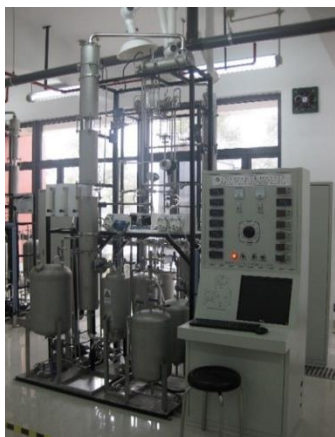
筛板精馏塔实验装置
