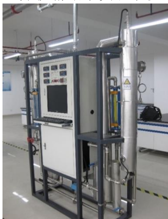
套管换热器传热系数综合实验装置
